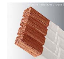
toron en nappe « planar » Section jusque 150mm² Largeur de 10 à 80mm épaisseur max 5mm brin unitaire Ø0,02 à 0,5mm
